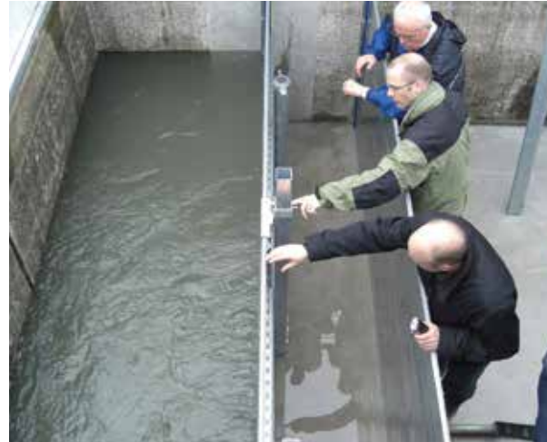
Stauversuch auf dem Firmengelände des Herstellers mit 4 Meter Breite und einer Stauhöhe von 1,2 Meter.
